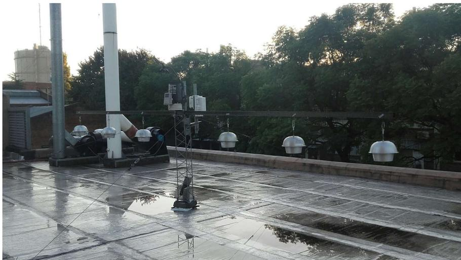
*Figura 2: muestreadores pasivos para muestras de aire*
