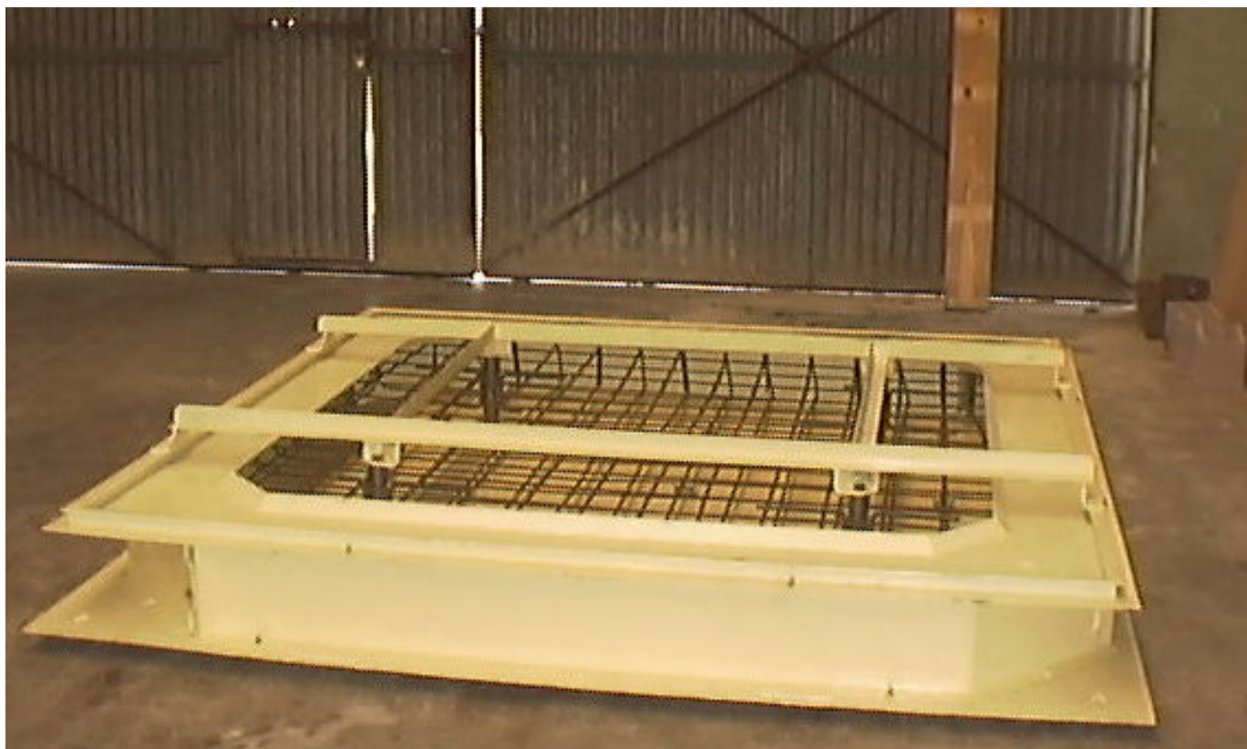
Molde de la tapa del contenedor
