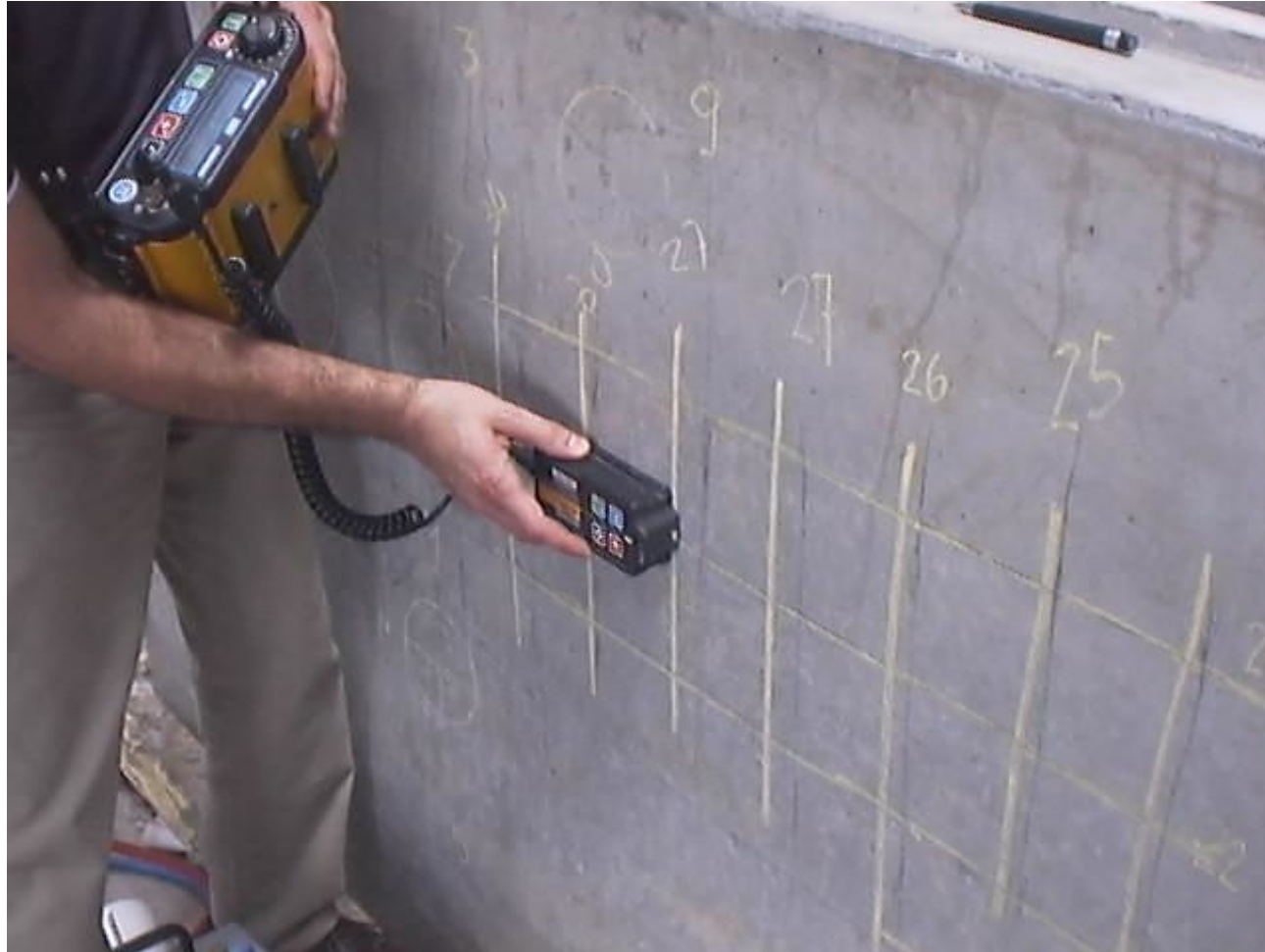
Determinación del espesor de recubrimiento
