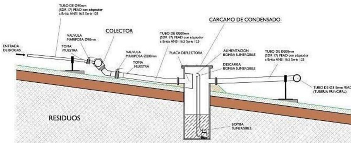
Figura 3. 12. Trampa de Condensado
