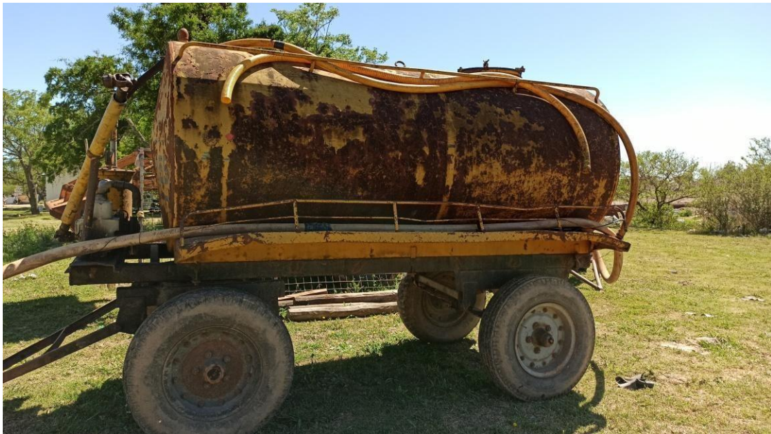
Figura 4. 20. Tanque Cisterna utilizado para la extracción y riego del lixiviado. Foto tomada por el INTI en noviembre de 2020.
