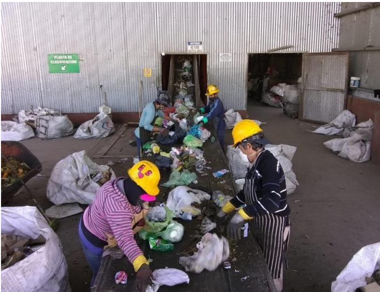
Figura 4. 7. Cinta de clasificación inicial y rotura de bolsas. Foto tomada por el INTI en noviembre de 2020.
