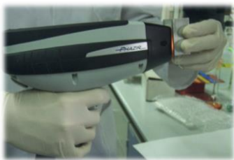
Figura 3.3 – Toma de espectro NIRS con el equipo microPHAZIR, empleando una cubeta de trans-reflectancia
